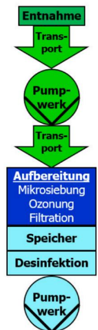
Abbildung 2: Blockschema der bestehenden Anlagen (Quelle: Machbarkeitsstudie H2U 2019)
