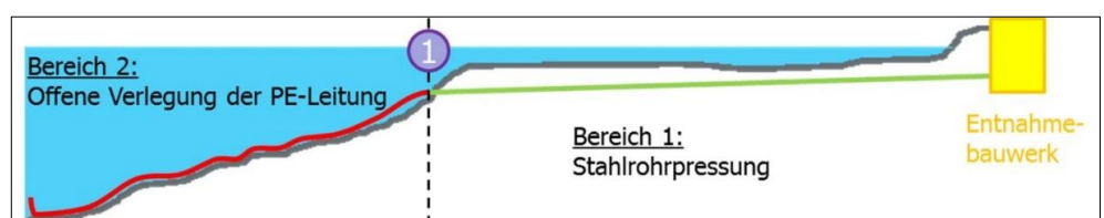
Abbildung 3: Verlegung neuer Entnahmeleitungen (Quelle: H2U 2019)
