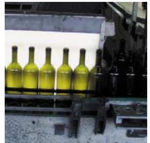
Optische Qualitätskontrolle von abgekühlten Flaschen
