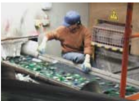
Die Aussortierung von Fremdstoffen ist immer noch mühsame Handarbeit
