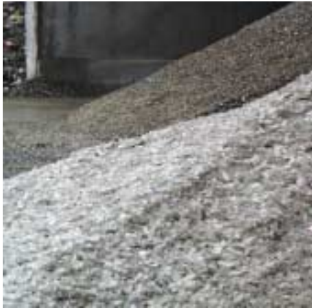
Weißglasgranulat fertig für die Schmelze
