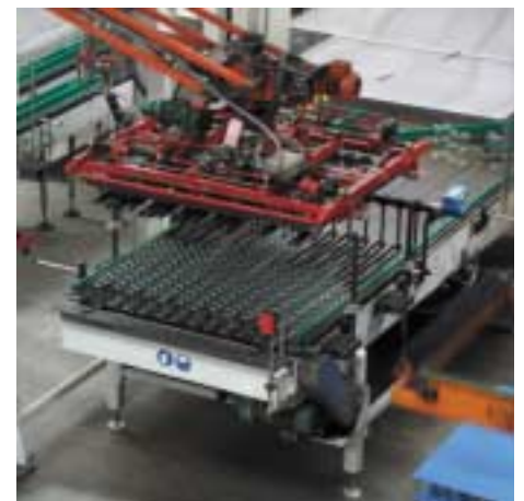
Vollautomatische Verpackung der fertigen Glasbehälter.
