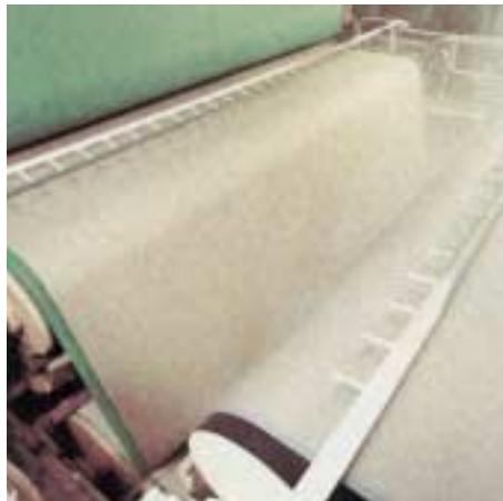
Die Bahnen laufen zusammen und werden vergautscht. Zur besseren Haftung wird Sprühstärke dazugegeben.
