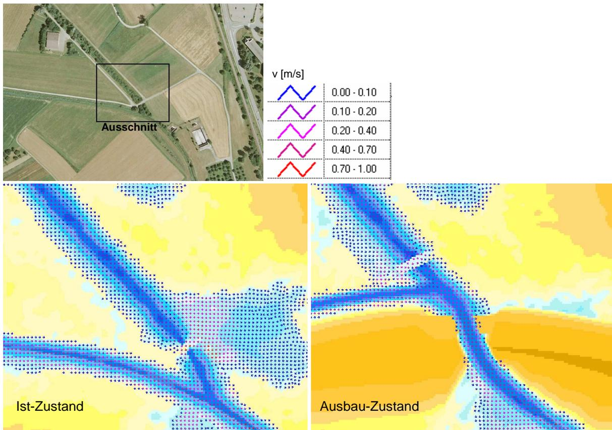
Abb. 10: Vergleich der Geschwindigkeitsvektoren im Bereich des Durchlasses [m/s]
