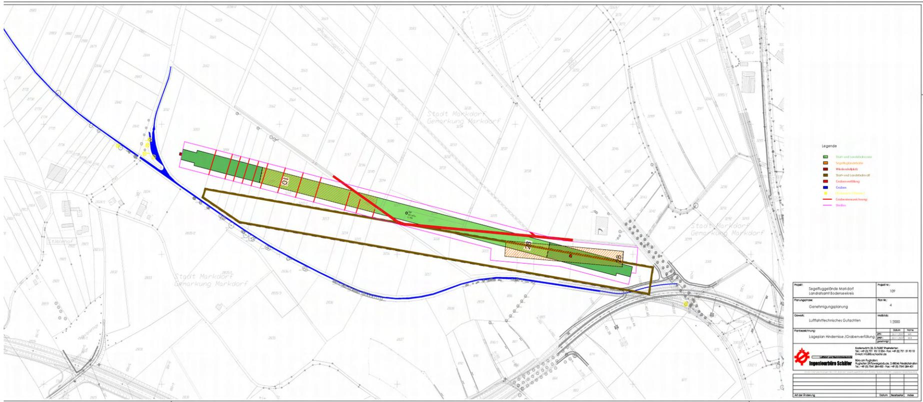
Abb. 87 Verlegung der Schlepptrecke / Start- und Landebahn des Segelfluggeländes Markdorf
