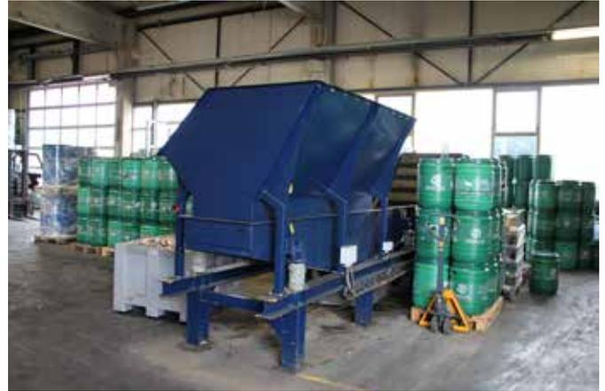
Die UNI-CYC Bremerhaven betreibt seit Anfang 2002 die weltweit größte Anlage zur Hochgeschwindigkeits-Sortierung von gebrauchten Gerätebatterien. Die Anlage arbeitet nach dem SORBAREC-Röntgen-Verfahren. Dieses Verfahren durchleuchtet die Batterien mithilfe von Röntgenstrahlen und erkennt sie so an ihrem elektrochemischen Inhalt.
