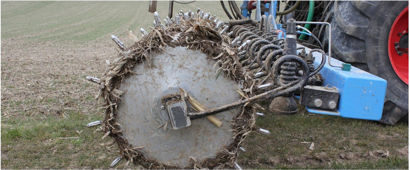
Abb. 7: Ausbringung von flüssigem Stickstoff-Dünger mittels Sternradtechnik zu Winterweizen im Frühjahr
