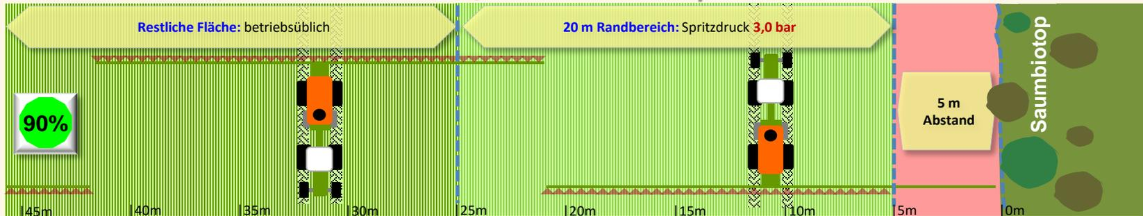
**Szenario 2:** Handelsprodukt „Saracen“, Auflage NT109 (Ausnahme), Gerät **Feldspritze mit ID120-03 POM**
