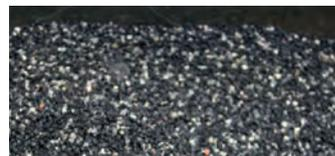
In Feinvermahlungsanlagen wird der Gummi anschließend zu verschiedenen Granulatkörnungen gemahlen.
