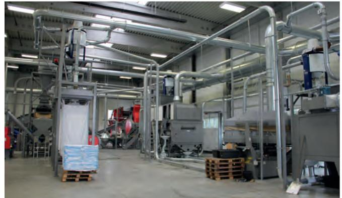
In zwei großen Silos werden die angelieferten Reifen zur Weiterverarbeitung zwischengelagert. Zunächst werden sie dann in etwa zehn Zentimeter große Stücke geschreddert. In mehreren Durchgängen werden die Teile nochmals zerkleinert und mit Hilfe von Magnet- und Luftstrahlabscheidern in ihre Grundbestandteile Gummi, Stahl und Textil zerlegt.
